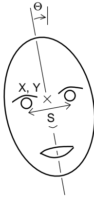
FIG. 2.4 – Nous définissons la position d'un visage dans le plan image à l'aide de quatre variables cachées : la position du centre des yeux X, Y , la distance entre les yeux S et l'inclinaison dans le plan image \Theta .
