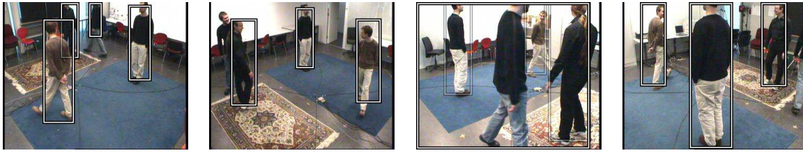
FIG. 2.7 – Exemples de résultats de suivi de personnes avec un système à quatre caméras. Les boîtes montrent le résultat de l’algorithme complet qui optimise les trajectoires sur plusieurs dizaines de frames selon un modèle combinant l’apparence et le mouvement.
