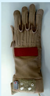
Ce gant (cyberglove) a été développé pour enregistrer et reproduire les mouvements quotidiens de la main.
